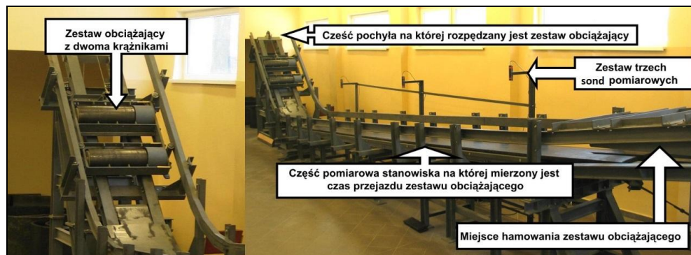
Rys. 10. Stanowisko pomiarowe do badania oporów toczenia metodą równi pochyłej Fig. 10. The measuring stand for rolling resistance testing using the incline method
