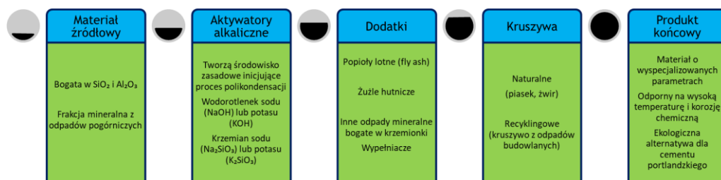
Rys. 4. Schemat procesu powstawania geopolimerów z materiałów bogatych w krzem i glin w środowisku alkalicznym; opracowanie na podstawie prezentacji projektu H2GEO
