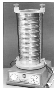
Rys. 9. Zestaw sit laboratoryjnych, model przesiewania i dane użyte do obliczeń Fig. 9. Set of laboratory sieves, screening model, and data used for calculations
