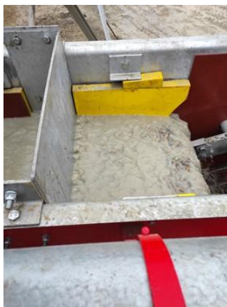
Rys. 8. Praca separatora, wyjście żwiru przez próg
