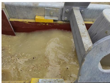
Rys. 6. Praca separatora, wymywanie zanieczyszczeń Fig. 6. Separator operation, washing out impurities
