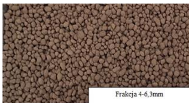
Rys. 4. Kruszywo wytworzone metodą granulacji dynamicznej, wypalone w temperaturze 1000°C
