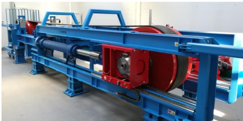
Rys. 5. Stanowisko do badań dynamicznych połączeń
