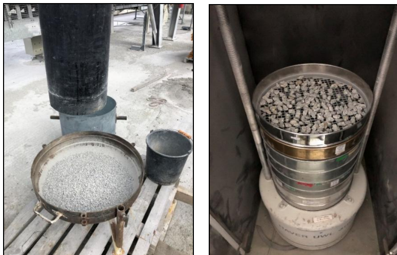
Rys. 5. Badania składu uziarnienia: efekt wykonania jednego zrzutu dla frakcji 2-8 (z lewej), widok wytrząsarki laboratoryjnej zastosowanej do badań, (z prawej)
