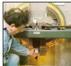
Rys. 12. Dawny i współczesny aparaty udarowe w laboratorium Allis-Chalmers
