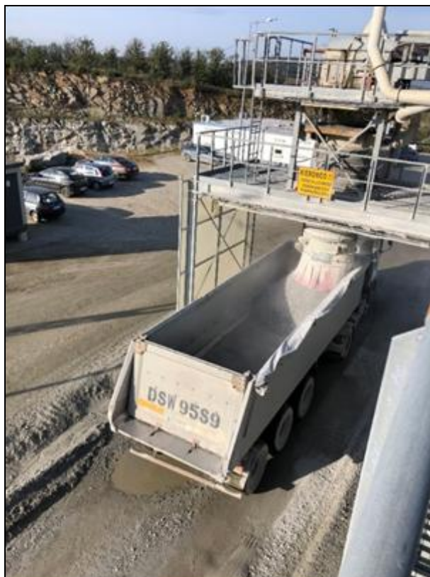
Rys. 1. Załadunek kruszywa w zakładzie przeróbczym na transport samochodowy Fig. 1. Loading of aggregate in a processing plant for tire transport
