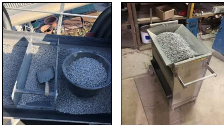
Rys. 4. Przygotowanie próbki do badań: pobranie prób z przenośnika taśmowego (z lewej), uniwersalny dzielnik prób DP do kwartowania (z prawej)
