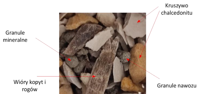
Rys. 10. Skład mieszanki nawozowo-mineralnej rdzenia wewnętrznego Fig. 10. The composition of the fertilizer-mineral mixture of the inner core
