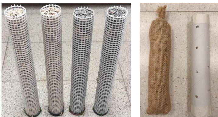
Rys. 8. Widok kompozycji mineralnej (od lewej) wykonanej w siatce plastikowej, jucie i tekturze Fig. 8. View of the mineral composition (from the left) made of plastic mesh, jute and cardboard
